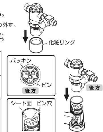
③取り付けナットを時計方向にまわしてねじ込み、モーターレンチ等で締め付ける。
