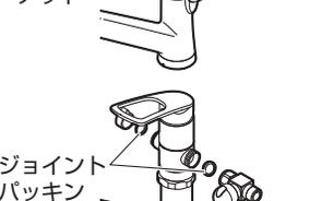
④湯側にジョイントパッキンと分岐コックを取り付ける。
