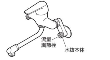
凍結のおそれがある場合に水抜部をまわして水栓内部の水を抜きます。
