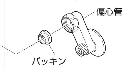
(2) モンキーレンチなどでナットをしっかりと締付け、水栓を偏心管に固定します。
