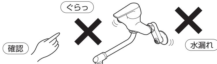
漏水を確認した場合は、流量調節栓または配管中の元栓を閉めてください。
