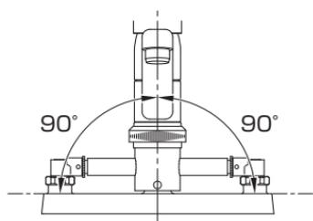
取付面に対して水平になるように注意して取付けてください。
