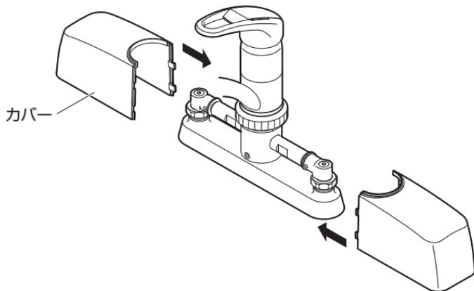
(2) カバーナットでカバーを固定して完了です。
