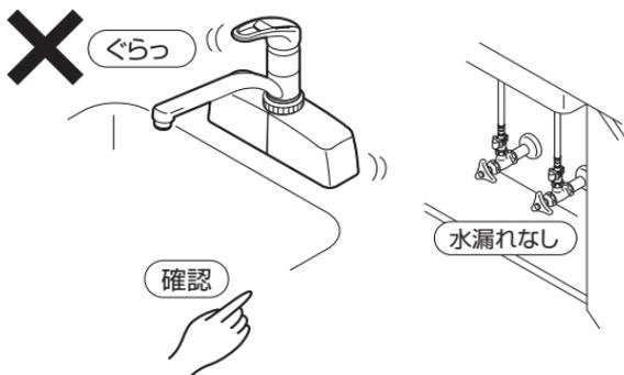
漏水を確認した場合は、止水栓または配管中の元栓を閉めてください。
