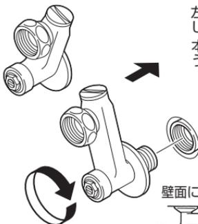
左右のナットが水平になるように注意して取付けます。
