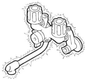
**!** ハンドル操作の急閉止は、配管からの漏水を起こす事があるので、ゆっくり操作してください。
