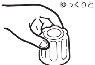
漏水した場合の処置：漏水した場合は元栓、または止水栓を閉めてください。
