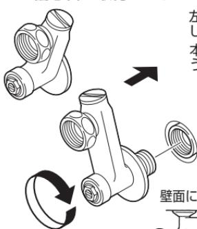
左右のナットが水平になるように注意して取付けます。
