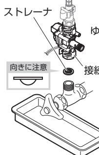
④電磁弁下部の取付金具をゆるめます。
