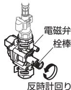
（※）停電時等に電力供給が遮断され、かつバックアップ電池での作動ができない状態に陥った場合を想定し、緊急措置として水を出せる状態にするためのものです。
