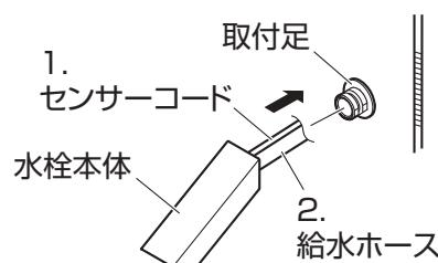
(5) 水栓本体をカウンターに十分密着させながら、止めねじで固定してください。
