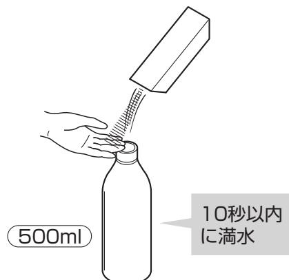
※ ストレーナ・吐水口の掃除をしても直らない場合は、止水栓で流量を調節してください。
