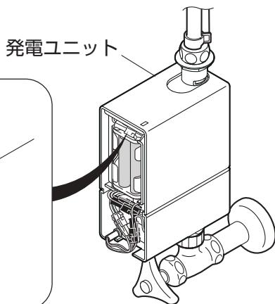
(6) コネクター接続後、LED照明が3回点滅した後、消灯します。
