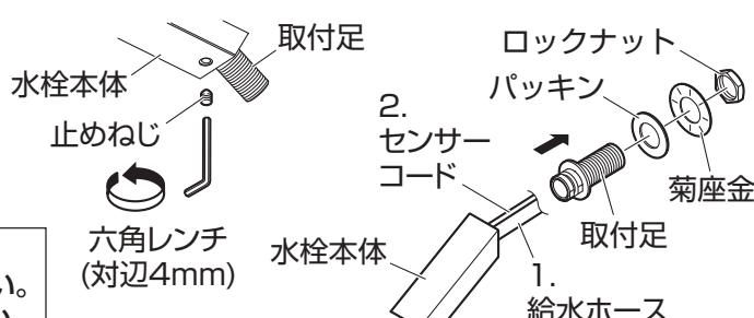
(3) 座パッキン裏面のはくり紙をはがし、取付足の切り欠き部分が垂直になるように、カウンターの表側からはめ込み、カウンターの裏側からパッキン・菊座金・ロックナットを取付け、固定します。
