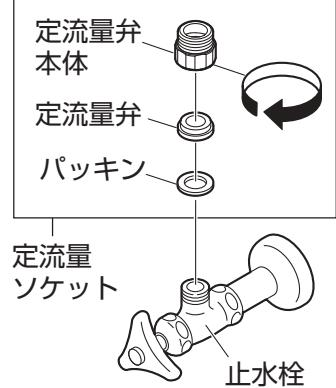
(2) 発電ユニット（AC100V仕様の場合は駆動部）のキャップを取りはずし、定流量ソケットに取付けてください。
