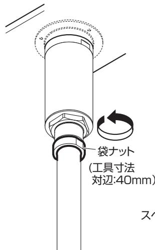
2.ストレートトラップキャップを緩めて下に下げる。
