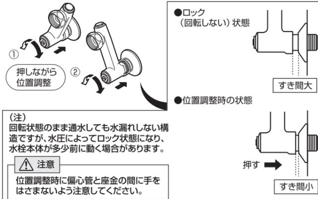
(2) 水栓本体と偏心管の間に、一般用は 水側：パッキン 湯側：逆止弁コア、寒冷地用は 水側：パッキン 湯側：パッキン組品が入っている事を確認し、手でナットを締付けていきます。
