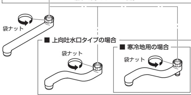
(3) モンキーレンチなどでナットをしっかりと締付け、水栓を偏心管に固定します。
