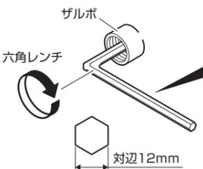
六角レンチがない場合 ザルボを配管の中に入れ、六角レンチの代わりに古い偏心管で締付けます。締付け後、古い偏心管をとりはずします。
