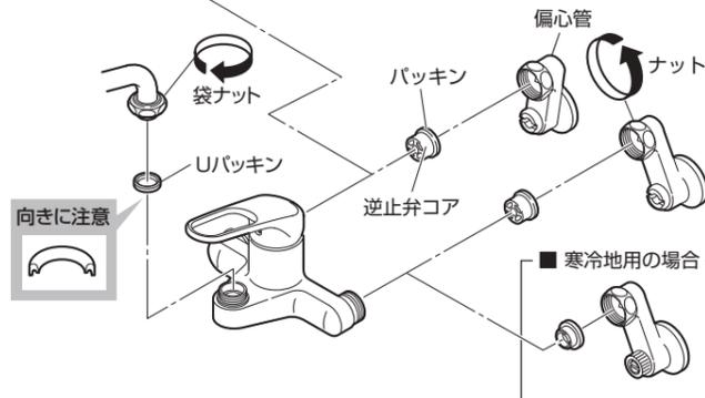
(2) モンキーレンチなどでナットをしっかりと締付け、水栓を偏心管に固定します。
