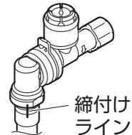
(2) クイックファスナーをシャワ側接続部とホース接続金具（寒冷地用は接続金具）の接続部（ツバ部）にカチッと音がするまで、確実にはめ込んでください。
