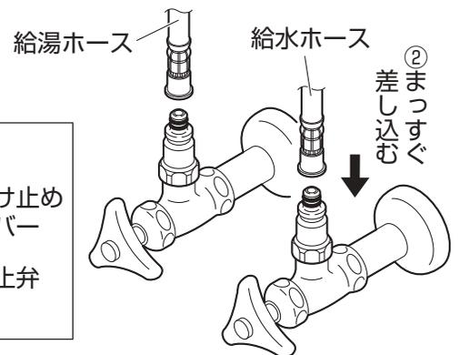
(2) クイックファスナーを給水・給湯ホースと逆止弁のツバ部に確実ににはめ込んでください。次に抜け止めカバーをクイックファスナーに確実ににはめ込んでください。
