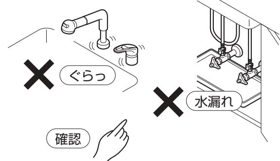
漏水を確認した場合は、止水栓または配管中の元栓を閉めてください。
