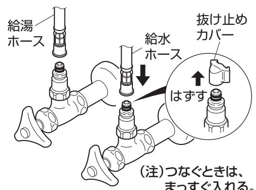
(2)クイックファスナーを給水・給湯ホースと逆止弁の接続部(ツバ部)に力ちと音がするまで、確実にはめ込んでください。次に抜け止めカバーをクイックファスナーに確実にはめ込んでください。
