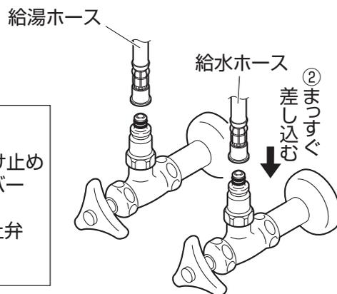
(2) クイックファスナーを給水・給湯ホースと逆止弁のツバ部に確実にはめ込んでください。次に抜け止めカバーをクイックファスナーに確実にはめ込んでください。
