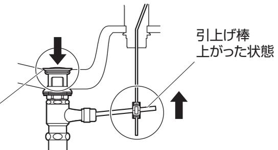
(4) 施工完了後、ポップアップ棒を動かして、取付足などの干渉がない事を確認してください。
