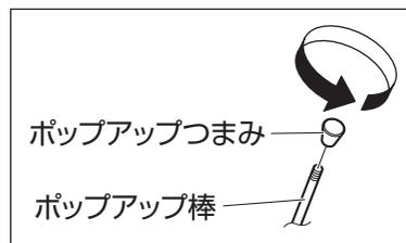
③ポップアップ棒の先端が穴に入っていることを確認したら、その状態でポップアップ棒を垂直にし、まっすぐ押し込みます。
