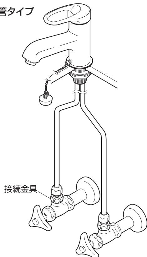
凍結のおそれがある場合にレバーを中央位置で上げて水栓内部の水を抜きます。参照：P19
