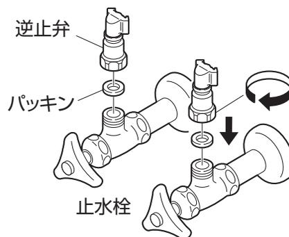
**6 逆止弁と給水・給湯ホースを接続します。**
