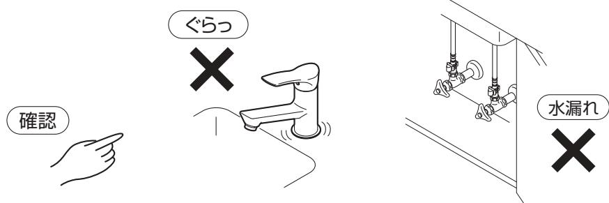
漏水を確認した場合は、止水栓または配管中の元栓を閉めてください。
