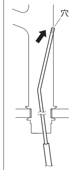
③ポップアップ棒の先端が穴に入っていることを確認したら、その状態でポップアップ棒を垂直にし、まっすぐ押し込みます。
