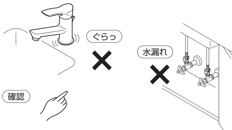
漏水を確認した場合は、止水栓または配管中の元栓を閉めてください。
