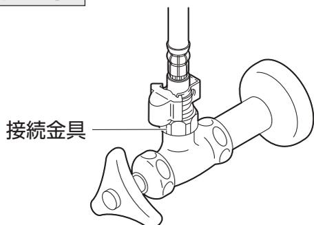
凍結のおそれがある場合にはレバーを中央位置で上げて水栓内部の水を抜きます。参照：P17
