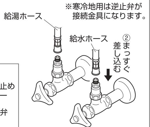
(2) クイックファスナーを給水・給湯ホースと逆止弁の接続部（ツバ部）にカチッと音がするまで、確実にはめ込んでください。次に抜け止めカバーをクイックファスナーに確実ににはめ込んでください。
