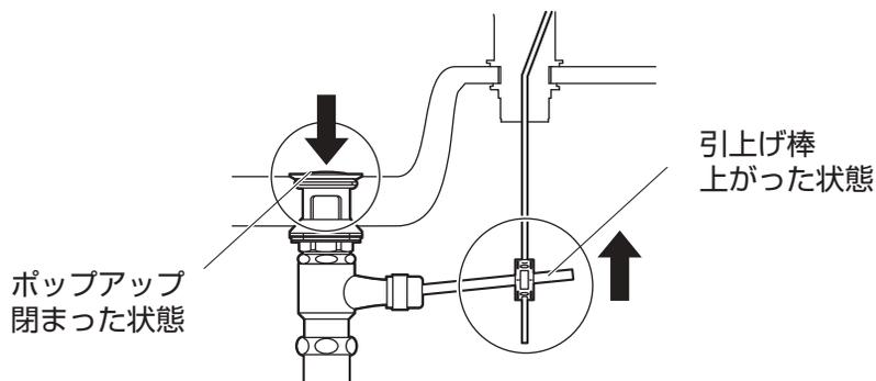
(2) 施工完了後、ポップアップ棒を動かして、取付足などの干渉がない事を確認してください。
