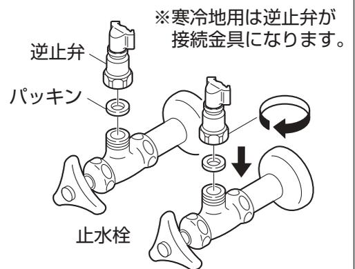
**7 逆止弁（寒冷地用は接続金具）と給水・給湯ホースを接続します。**
