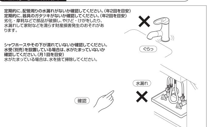
漏水を確認した場合は、止水栓または配管中の元栓を閉めてください。 修理の依頼をされる場合は、「保証とアフターサービス」(P22)を参照してください。
