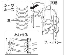
2 はずれ止めの穴にツメを入れます。 (右側2箇所、左側2箇所)
