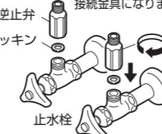
6 逆止弁（寒冷地用は接続金具）と給水・給湯パイプを接続します。
