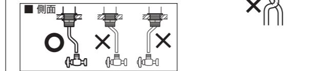
5 逆止弁（寒冷地用は接続金具）を取り付けます。
