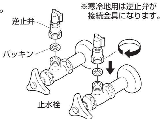
**6 逆止弁（寒冷地用は接続金具）と給水・給湯ホースを接続します。**
