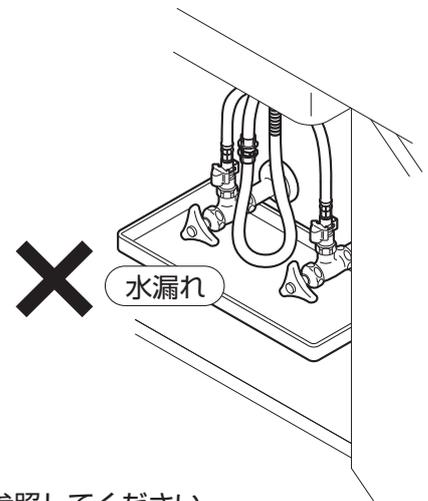
漏水を確認した場合は、止水栓または配管中の元栓を閉めてください。
