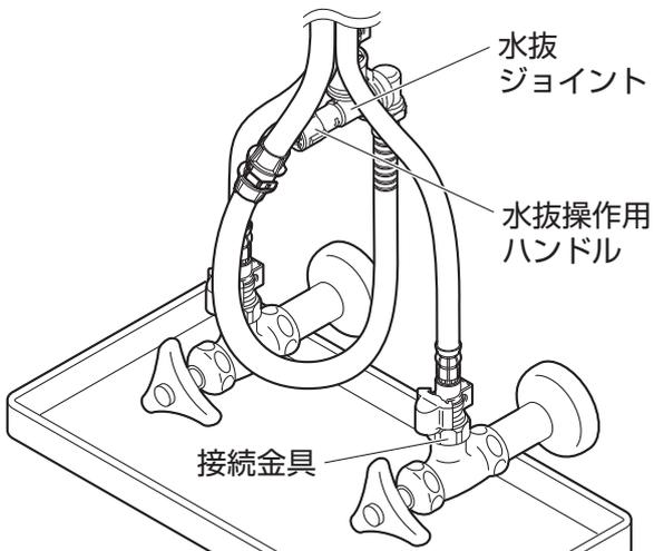
凍結のおそれがある場合に水抜操作ハンドルをまわして水栓内部の水を抜きます。参照：P19
