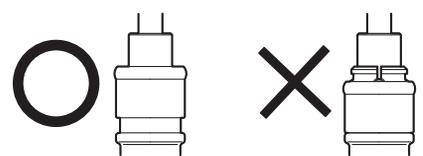
(2) カバーをワンタッチ接手のロック部へカチッと音がするまで確実に接続してください。
