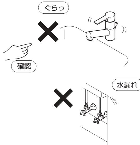
漏水を確認した場合は、止水栓または配管中の元栓を閉めてください。
