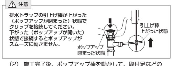
(2) 施工完了後、ポップアップ棒を動かして、取付足などの干渉がない事を確認してください。
