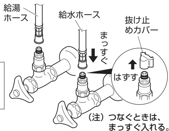
(2) クイックファスナーを給水・給湯ホースと逆止弁の接続部(ツバ部)に力ちッと音がするまで、確実にはめ込んでください。
