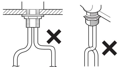
(2) 本体が正面を向くように締付工具で固定し、給水・給湯パイプを止水栓などの取出し芯に合うように曲げてください。
