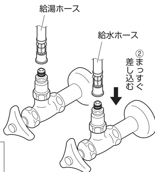
(2) クイックファスナーを給水・給湯ホースと逆止弁のツバ部に確実ににはめ込んでください。次に抜け止めカバーをクイックファスナーに確実ににはめ込んでください。
