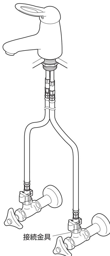
凍結のおそれがある場合にレバーを中央位置で上げて水栓内部の水を抜きます。
