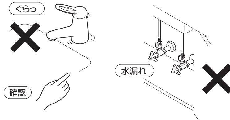
漏水を確認した場合は、止水栓または配管中の元栓を閉めてください。
