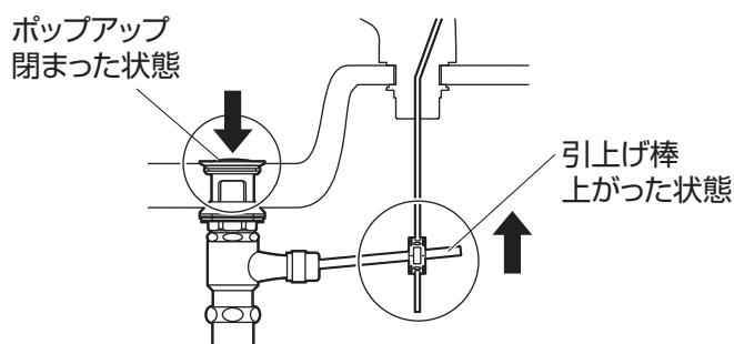
(2) 施工完了後、ポップアップ棒を動かして、取付足などの干渉がない事を確認してください。
