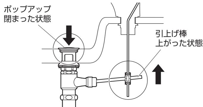
(3) 施工完了後、ポップアップ棒を動かして、取付足などの干渉がない事を確認してください。
