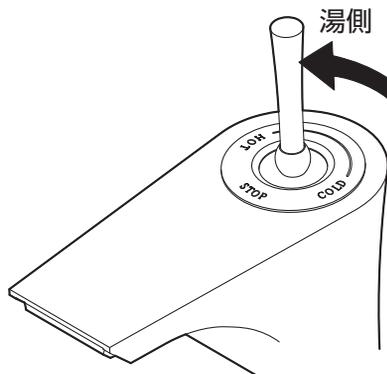
(注) 水温の高い夏場で吐水量を少なくして使うと瞬間式給湯機の場合、着火しないことがあります。この場合には、水栓側のレバーを全開に（吐水量を多く）するか、給湯機の温度設定を下げてください。
