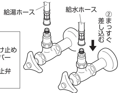
(2) クイックファスナーを給水・給湯ホースと逆止弁のツバ部に確実にはめ込んでください。次に抜け止めカバーをクイックファスナーに確実にはめ込んでください。
