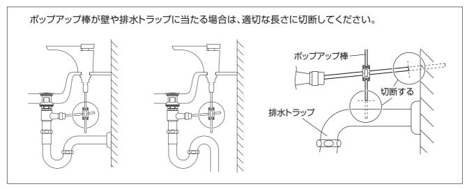
(3) 施工完了後、ポップアップ棒を動かして、取付足などの干渉がない事を確認してください。
