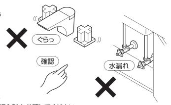
漏水を確認した場合は、配管中の元栓を閉めてください。
