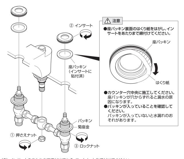
(2) インサートをあたりまで締付けてから、ロックナットを締付けてください。
