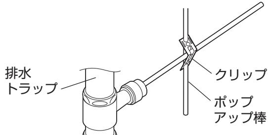
(3) 施工完了後、ポップアップ棒を動かして、取付足などの干渉がない事を確認してください。
