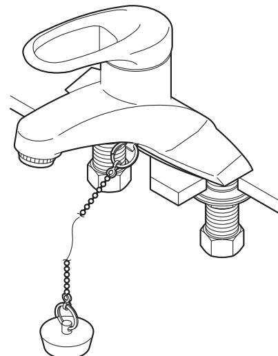
凍結のおそれがある場合にレバーを中央位置で上げて水栓内部の水を抜きます。参照：P13
