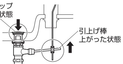
(4) 施工完了後、ポップアップ棒を動かして、取付足などの干渉がない事を確認してください。
