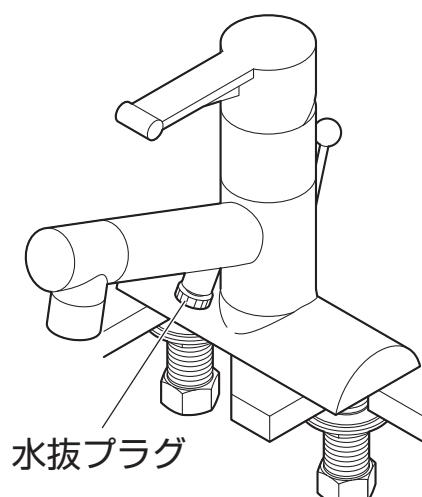
凍結のおそれがある場合に水抜部をまわして水栓内部の水を抜きます。
