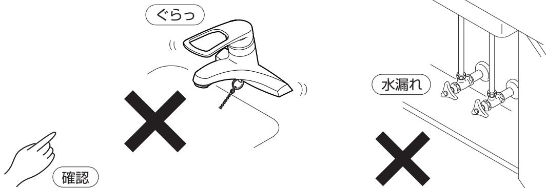
漏水を確認した場合は、止水栓または配管中の元栓を閉てください。
