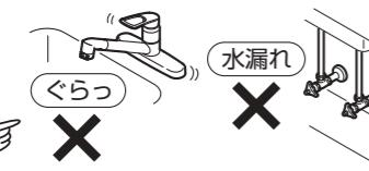
漏水を確認した場合は、止水栓または配管中の元栓を閉めてください。修理の依頼をされる場合は、「保証とアフターサービス」を参照してください。
