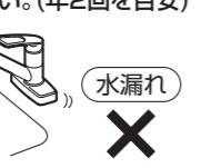
漏水を確認した場合は、止水栓または配管中の元栓を閉めてください。
