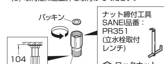
(4) 取付けた逆止弁に銅管を接続してください。
