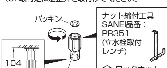
(4) 取付けた逆止弁に銅管を接続してください。
