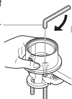
(6) 六角レンチを横にして、左右のボルトを増し締めし、上取付フランジを確実に固定してください。
