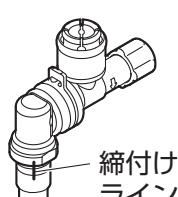
(2) クイックファスナーをシャワ側接続部とホース接続金具（寒冷地用は接続金具）の接続部（ツバ部）に力チッと音がするまで、確実にはめ込んでください。
