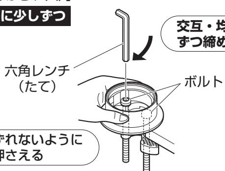
(6) 六角レンチを横にして、左右のボルトを増締めし、上取付フランジを確実に固定してください。
