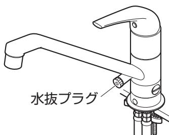
凍結のおそれがある場合に水抜部をまわして水栓内部の水を抜きます。参照：P22
