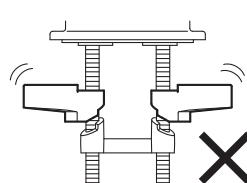
(5) 上取付フランジの位置がずれないように押さえながら、六角レンチをたてにし、左右のボルトを**交互・均等に少しづつ締め**、回らなくなるまで締め付けてください。
