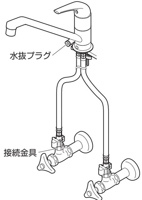
凍結のおそれがある場合に水抜部をまわして水栓内部の水を抜きます。参照：P23
