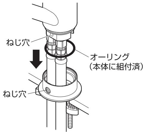
(3) 止めねじで本体を確実に固定し、ビスキャップでねじ穴をふさいでください。
