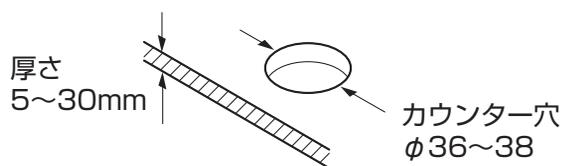
(2) 上取付フランジのツメを閉じた状態にして、ねじ穴が正面を向くようにカウンター穴に入れてください。
