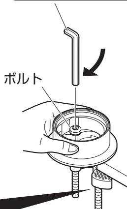
(5) 六角レンチを横にして左右両方のボルトを一回転増締めして上取付フランジを確実に固定してください。
