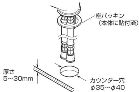
(2) 本体が正面を向くように締付工具で固定してください。(取付金具は下図取付順にて施工ください)
