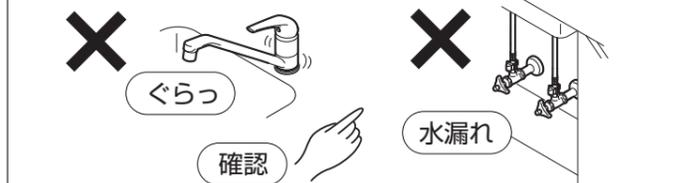
漏水を確認した場合は、止水栓または配管中の元栓を閉めてください。修理の依頼をされる場合は、「保証とアフターサービス」を参照してください。
