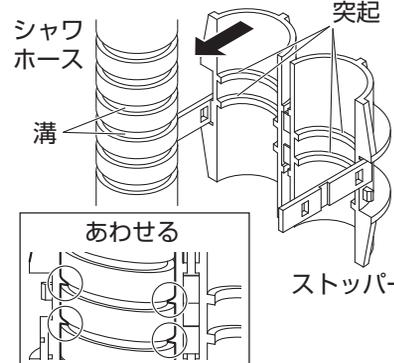
2 はずれ止めの穴にツメを入れます。(右側2箇所、左側2箇所)
