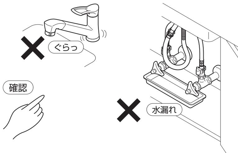
漏水を確認した場合は、止水栓または配管中の元栓を閉めてください。
