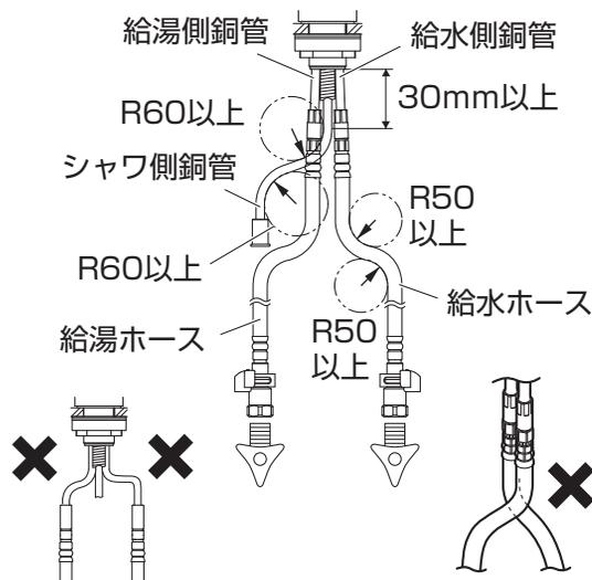
(4) 固定後、(2) ではずしたホース接続金具（寒冷地用の場合は水抜ジョイント）をシャワーホースに取付けてください。
