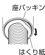
●カウンター穴中央に施工してください。座パッキンが穴からずれると漏水の原因になります。
