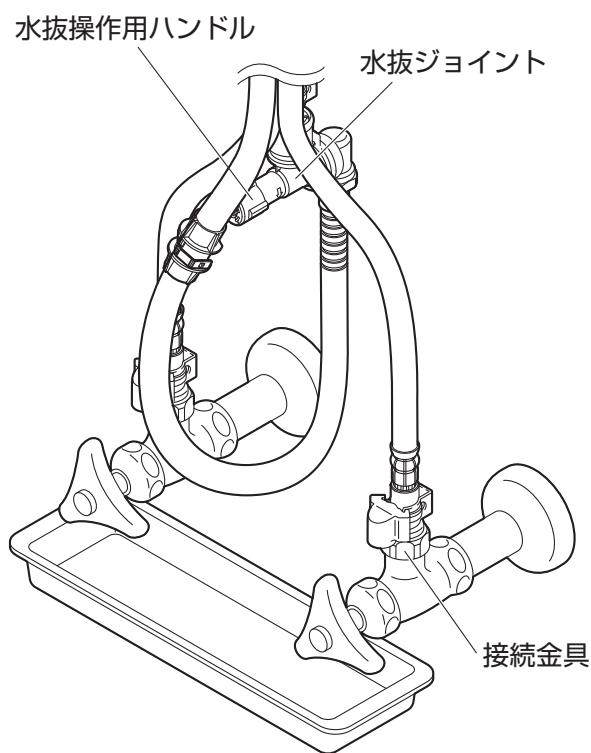
凍結のおそれがある場合に水抜操作用ハンドルをまわして水栓内部の水を抜きます。参照：P16
