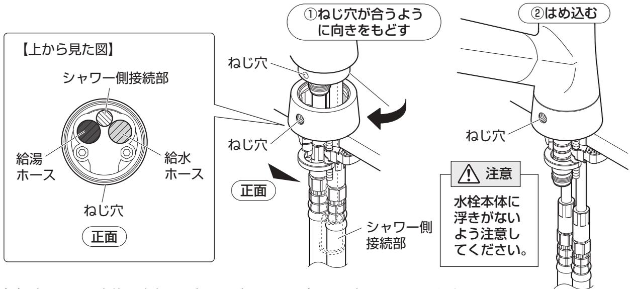
(5) 止めねじで本体を確実に固定し、ビスキャップでねじ穴をふさいでください。
