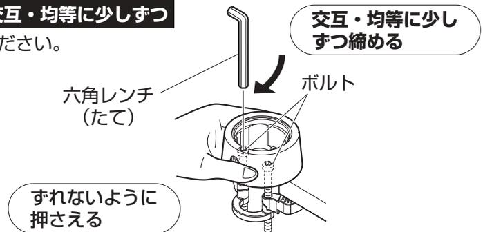
(6) 六角レンチを横にして、左右のボルトを増締めし、上取付フランジを確実に固定してください。
