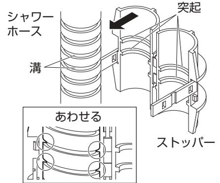
2 はずれ止めの穴にツメを入れます。(右側2箇所、左側2箇所)
