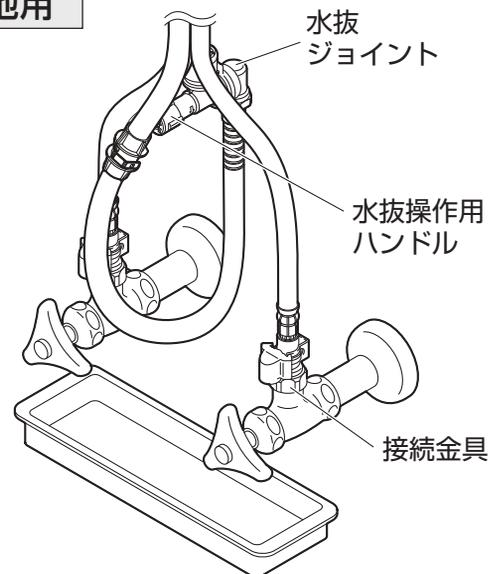
凍結のおそれがある場合に水抜操作ハンドルを回して水栓内部の水を抜きます。参照：P26
