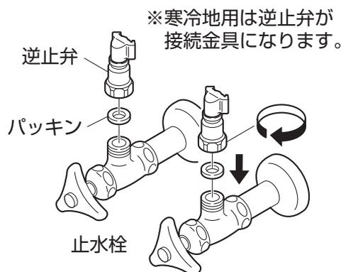
**7 逆止弁（寒冷地用は接続金具）と給水・給湯ホースを接続します。**
