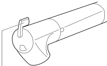
切替レバー シャワー吐水（原水） — ストレート吐水（原水） — ストレート吐水（浄水）
