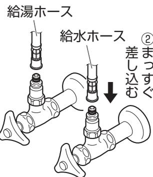
(2) クイックファスナーを給水・給湯ホースと逆止弁のツバ部に確実にはめ込んでください。次に抜け止めカバーをクイックファスナーに確実にはめ込んでください。
