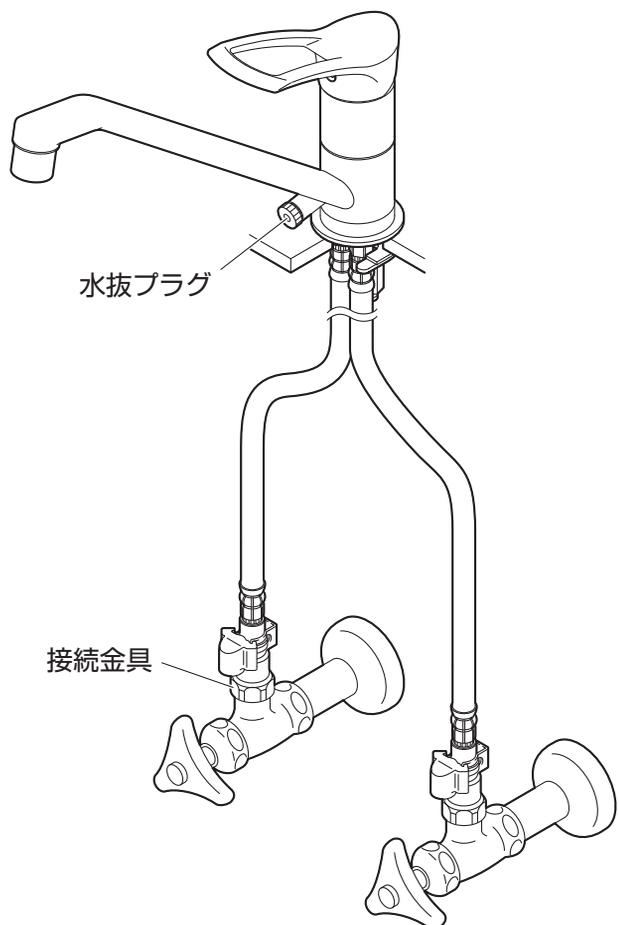
凍結のおそれがある場合に水抜部をまわして水栓内部の水を抜きます。参照：P15
