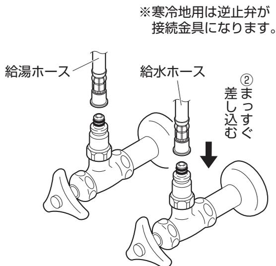
(2) クイックファスナーを給水・給湯ホースと逆止弁のツバ部に確実にはめ込んでください。
