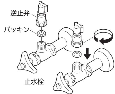
**5 逆止弁と給水・給湯ホースを接続します。**
