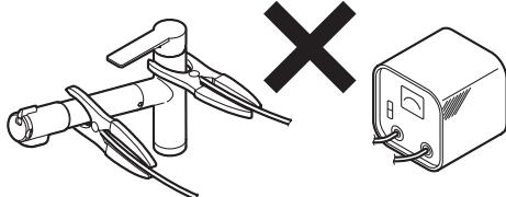
水栓が発熱で破損し、家財などを濡らす財産損害発生の
