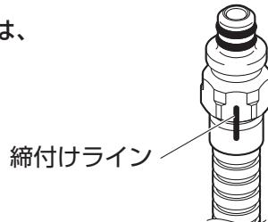
(2) クイックファスナーをシャワー側接続部とホース接続金具のツバ部に確実にはめ込んでください。次に抜け止めカバーをクイックファスナーに確実にはめ込んでください。
