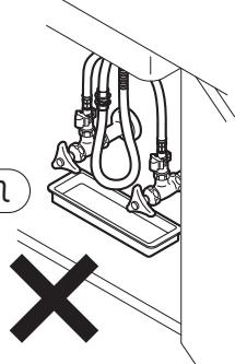
漏水を確認した場合は、止水栓または配管中の元栓を閉めてください。
