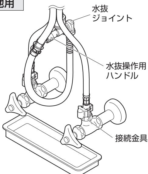
凍結のおそれがある場合に水抜操作用ハンドルを回して水栓内部の水を抜きます。参照：P23
