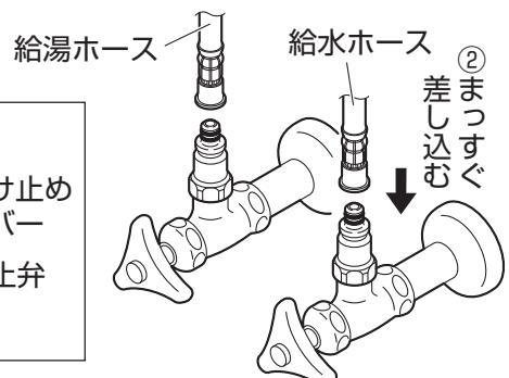
(2) クイックファスナーを給水・給湯ホースと逆止弁のツバ部に確実にはめ込んでください。
