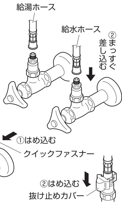
(2) クイックファスナーを給水・給湯ホースと逆止弁のツバ部に確実にはめ込んでください。
