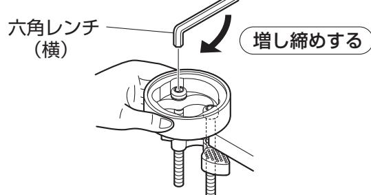
(6) 六角レンチを横にして、左右のボルトを増し締めし、上取付フランジを確実に固定してください。
