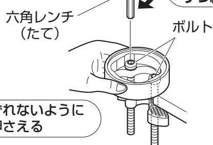
(5) 上取付フランジの位置がずれないように押さえながら、六角レンチをたてにし、左右のボルトを **交互・均等に少しずつ締め**、回らなくなるまで締め付けてください。
