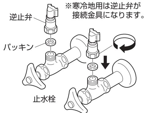
**6 逆止弁（寒冷地用は接続金具）と給水・給湯ホースを接続します。**
