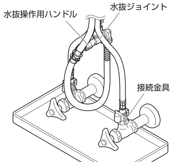
凍結のおそれがある場合に水抜操作ハンドルをまわして水栓内部の水を抜きます。参照：P17
