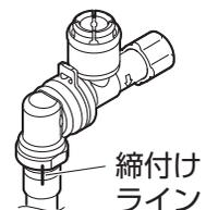
(2) クイックファスナーをシャワ側接続部とホース接続金具（寒冷地用は接続金具）の接続部（ツバ部）にカチッと音がするまで、確実にはめ込んでください。
