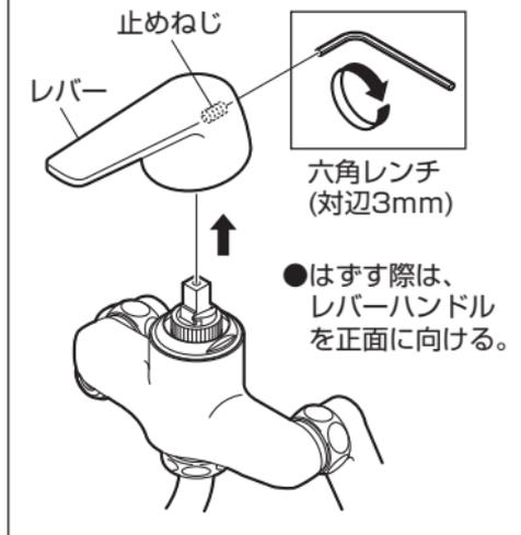
3. カートリッジの軸に、新しいレバーハンドルを取付ける。
