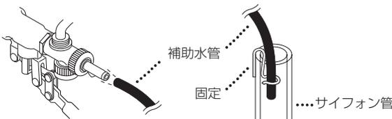
水を流すときレバー部分が補助水管にあたらないように取付けます。
